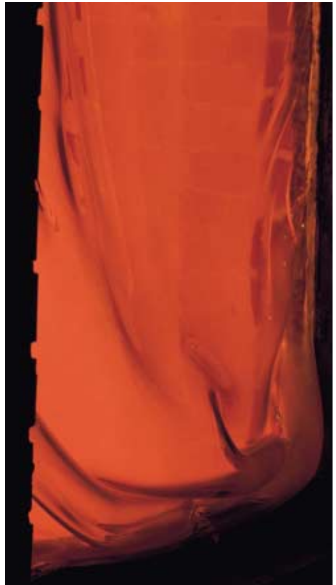
Pyran® Brandschutzglas widersteht dem Feuer, ohne zu zerspringen.
