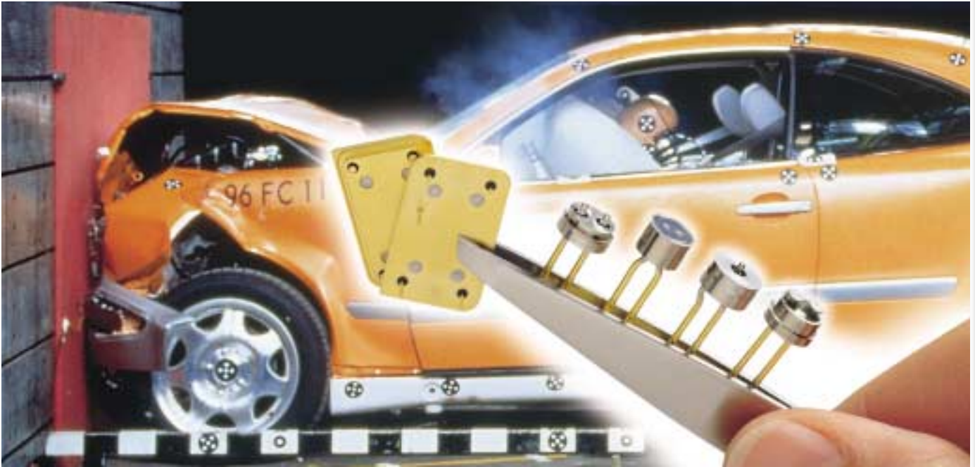
Wichtig für die Funktionsfähigkeit der Elektronik: Glas-Metall-Komponenten für Airbag und Gurtstraffer.
