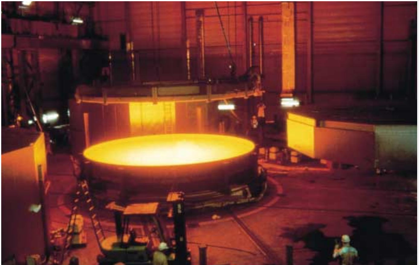
8,2 m-Teleskopspiegelträger, Zerodur® Glaskeramik.
